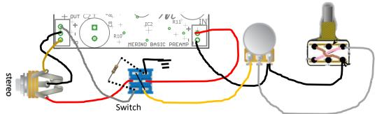
Agregar Switch activo/pasivo (para evitar el ruido de pop al cambiar entre activo y pasivo se agrega una resistencia de 12K entre la salida del preamp y tierra)
